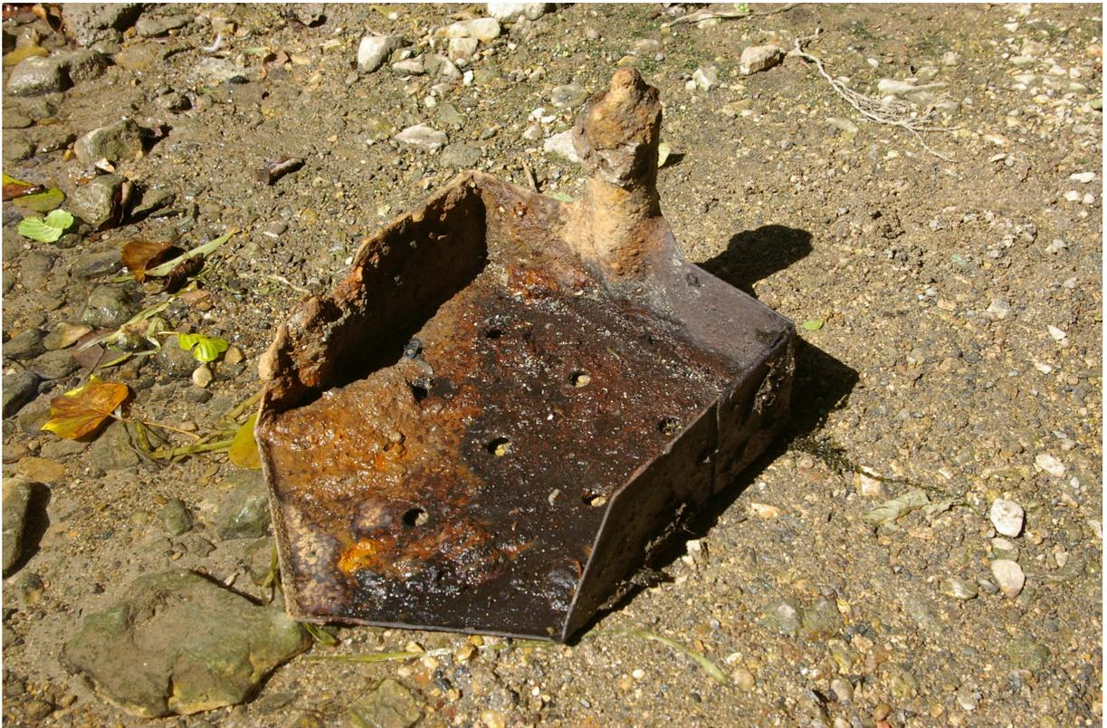
Cet artefact ressemble assez à une « queue de singe » utilisée pour recueillir le sable au fond des rivières (voir dessin ci-dessous) sauf que les trous d'évacuation de l'eau sont sur les côtés et non sur le fond. Il a été réalisé dans une tôle en fer découpé et mise en forme par pliage. Les parties se recouvrant ont été rivetées.
